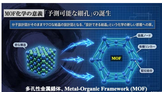
図 3 MOF 化学の学術的意義。密な構造が安定という常識を覆し、有機分子を用いても頑丈な多孔性構造が構築可能であることを実証
