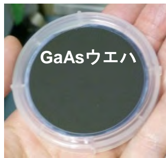
図 1. 分子線エピタキシー法での結晶成長時に使用する GaAs 系試料の外観
