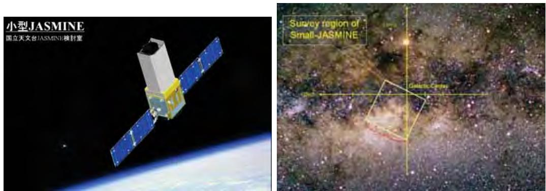
図 3.4 左図は、小型 JASMINE 衛星のイメージ図。小型 JASMINE は、高度約 550km の太陽同期軌道とよばれる地球周回軌道を回る。右図は、銀河系中心付近の観測領域を示す。座標は銀河座標で横軸は銀緯、縦軸は銀経をあらわす。銀経軸および銀緯軸から 30 度程度傾いた正方形が、サーベイを予定している  $3^\circ \times 3^\circ$  の観測領域である。ただし、まだ固定はしておらず、今後、サイエンス等の検討にもとづき観測領域の多少の変更はありえる。なお、小型 JASMINE は、春と秋に、この観測領域をサーベイするが、その他の季節は、CygX-1 やガンマ線連星系、系外惑星系、星形成領域など科学的に興味があり、他にはない小型 JASMINE の特徴(近赤外線での観測や高時間分解能など)を活かせる特定天体をターゲットにして位置天文観測を行う予定である。
