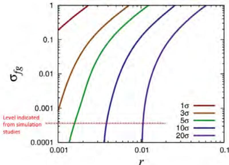
図2.7 LiteBIRDで期待される原始重力波発見の有意度をテンソル・スカラー比の値(横軸)とパワースペクトルにおける残余前景放射成分の割合(縦軸)の二次元上にあらわした図。シミュレーションによる残余前景放射の見積もりレベル(鎖線)は、前景放射を考慮しても、十分な余裕を保ってフルサクセスを達成できることを示している。
