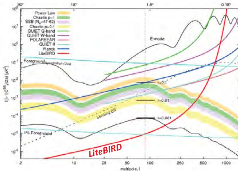
図2.6 インフレーション宇宙理論から期待される代表的なCMB偏光Bモードパワースペクトルと、LiteBIRDの感度目標曲線。参考のため、Planckや地上実験で期待される感度曲線も示す。
