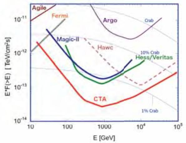
図 4.4 左図：CTA 国際宇宙ガンマ線天文台のイメージ。手前に見えるのが、23m 大口径望遠鏡。右図：CTA の設計感度曲線。従来の装置と比べ一桁高い感度と、20GeV から 100TeV のエネルギー領域をカバーする。
