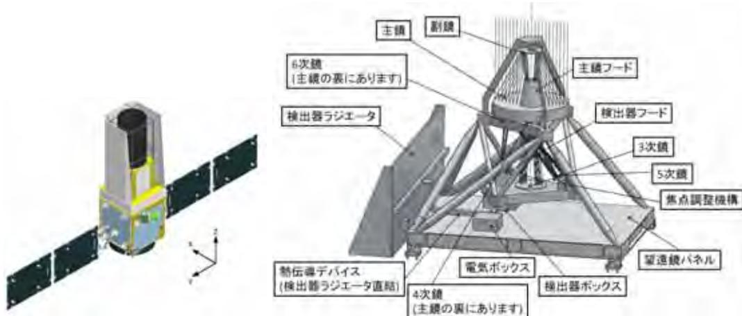
図 3.5 左図は、衛星の外観図。太陽電池パドルが両側についた四角い箱は衛星バス部（小型科学衛星用の標準バスを使用）、その上に搭載されているのがミッション部である。衛星の総質量は 340kg 程度の見込みである。ミッション部の中の四角い箱の中に望遠鏡が収められている。この四角い箱の上に搭載されている円柱状のものは、望遠鏡への迷光侵入を防ぐフードである。右図は、望遠鏡の構造図。望遠鏡は、光学素子をトラス構造で支持している。望遠鏡の光学系は 3 枚鏡のコルシュ系であり、主鏡口径 30cm、焦点距離 3.9m、視野面積は  $0.6^\circ \times 0.6^\circ$  である。検出器は、位置天文観測用に HAWAII-4RG を 1 個用いる。ミッション部の下部は望遠鏡パネルを介して衛星バス部に接続され、衛星バス部の熱変形が望遠鏡構造へ影響しにくい構造となっている。左側の板状の部品は検出器冷却用の放熱板（ラジエータ）である。
