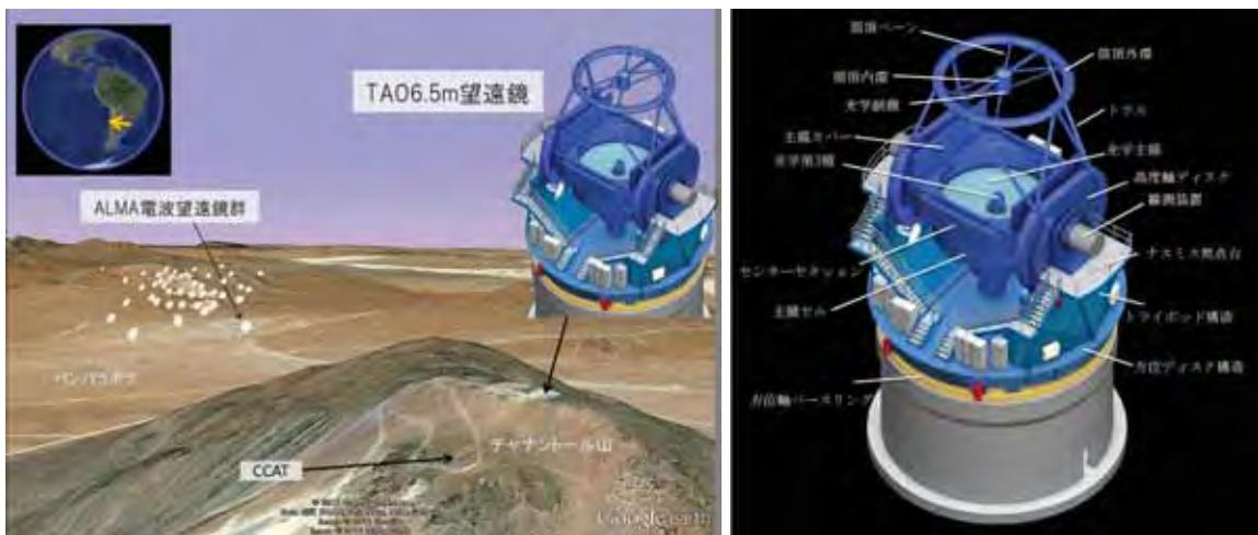
図 3.6 (左) TAO が建設されるアタカマ・チャナントール山。山頂（標高 5,640m）の地点に TAO6.5m 望遠鏡は建設される。(右) TAO 望遠鏡の概念図。望遠鏡架台はトライポッドディスクを採用しており、ナスマス焦点およびベントカセグレン焦点を備えたカセグレンタイプの望遠鏡である。
