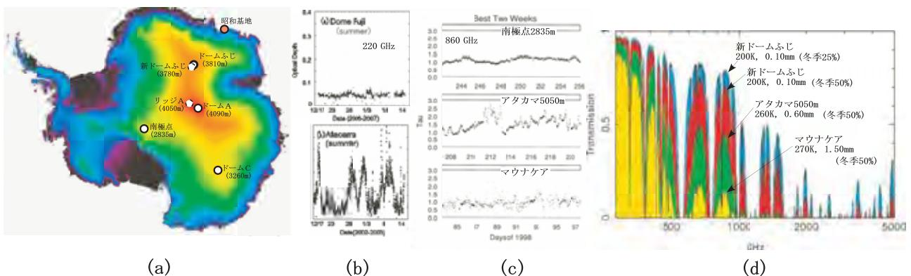
図 2.3 (a) 南極大陸高原地帯にある(新)ドームふじ基地と他の主要な基地の位置を示す。グレーは標高を示す。ドーム A には中国が、ドーム C には欧州が基地を持つ。米国は南極点に基地を持つほかリッジ A に基地を建設する構想がある。(b) 上図がドームふじ基地で 2006 年 12 月 17 日から夏季 1 か月間測定した 220GHz での大気の光学的厚みである (Ishii,S., et al. 2010)。下図は 2002 年同日から 1 か月間のチリのアタカマ 5050m での値。(c) 南極点、アタカマ 5050m、マウナケアでの 1998 年における連続する 2 週間で最も安定な大気の光学的厚みを表示したもの。ドームふじでは南極点よりもさらに安定であることが期待される。(d) 衛星データによる可降水量に基づく各地の大気透過率の推定値 (Yang,H., et al. 2010)。新ドームふじ基地はドーム A と同程度という推定から。
