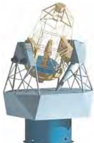
図 6.3 ドイツが建設した口径 1.5m の太陽望遠鏡。開放型望遠鏡技術による低コスト中口径装置であり、本計画の概念に近い先行装置であるので、参考として掲げる。
