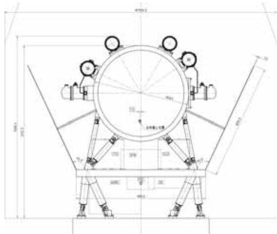
図 5.4 検討中の DIOS のデュワーを正面から見た図。胴体の直径が 66.5 cm、放射板に角度がつけられている。
