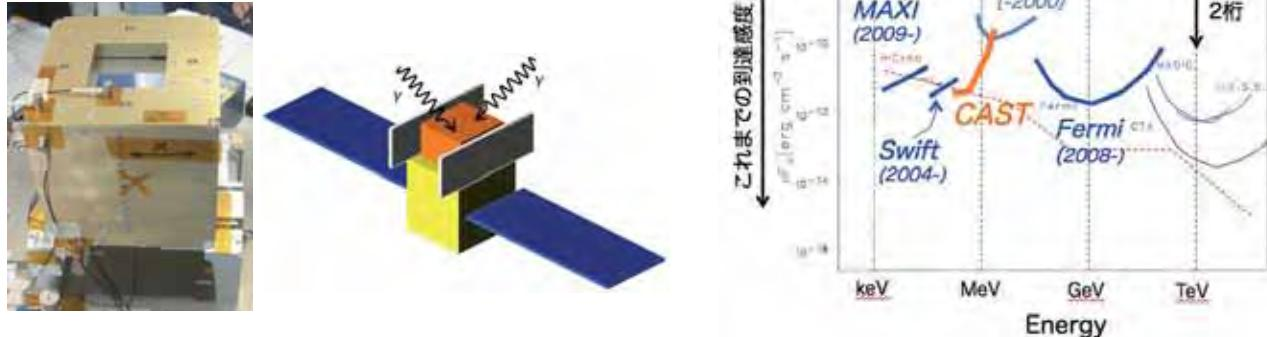
図 5.10 (左) ASTRO-H/SGD 検出器の Si/CdTe コンプトンカメラ。10 cm 立方の検出器の中に、13,000 ch の半導体検出器が収まっている。(中) CAST の概念図。主検出器と回路部、ラジエータで構成される。本図では小型専用衛星オプション(下半分がバス部)の場合を示した。(右) 2000 年代の主要な X 線・ガンマ線の全天観測装置の検出感度。CAST の観測帯域と、2 年間の運用で期待される到達感度を示した。
