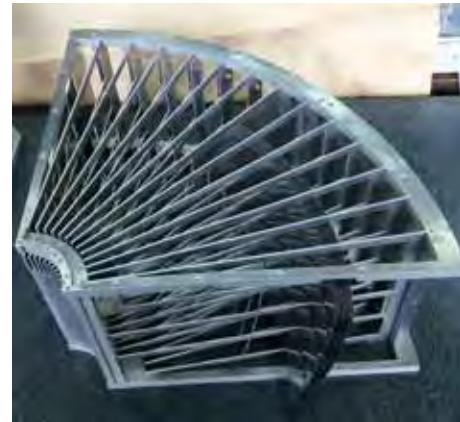
図 5.6 口径 60 cm の 4 回反射 X 線望遠鏡の 1/4 分割部の新しいハウジング。4 段一体型アライメントプレートが用いられている。
