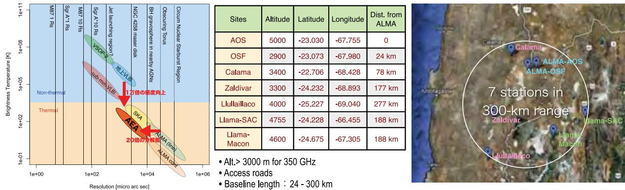
図 2.1 左:干渉計の分解能（横軸）と輝度温度感度（縦軸）。AEA は VLBI に比べて 1 万倍の輝度温度感度向上、ALMA に比べて 20 倍の分解能向上をもたらし、熱的放射を最高分解能で観測する。右:AEA のアレイ配列案。AOS, OSF は ALMA の山頂サイトと山麓施設、LLAMA 計画の 2 局も記してある。
