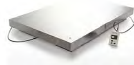
図1 鹿屋体育大学スポーツパフォーマンス研究センターにおける撮影装置と1mサイズのフォースプレート
