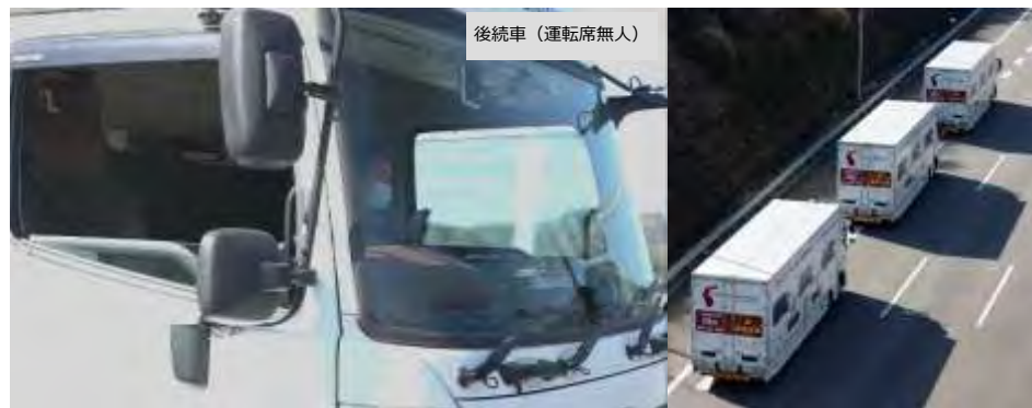
後続車無人隊列走行の様子（2021年2月22日 新東名高速道路） 安全のために後続車助手席には保安要員乗車
