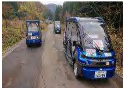
1人の遠隔運転手が3台の無人自動運転車両を運行
