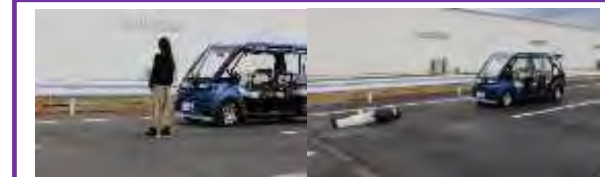
空転試験（スリップ模擬）の様子
