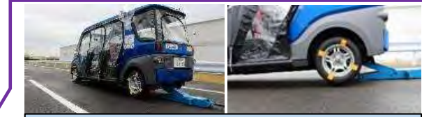
空転試験（スリップ模擬）の様子
