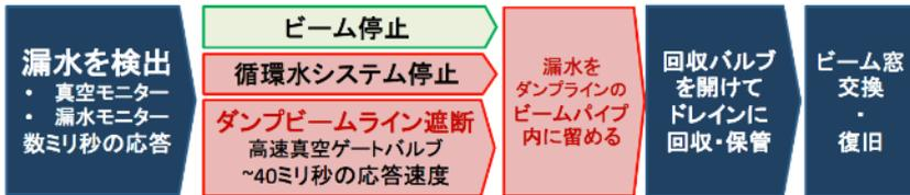
漏水検出から高速ゲートバルブ遮断まで~100ミリ秒
