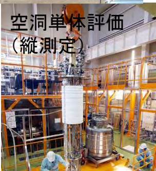
S1グローバル(2010) KEK4台、ドイツ・米国から2台ずつの空洞試験
