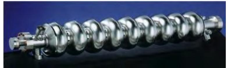
1.3GHz (L-band)超伝導加速空洞
