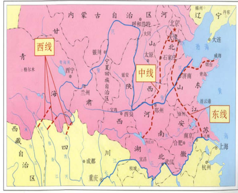
图8 南水北调工程总体布局图
