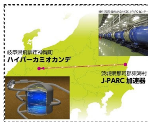
図 2 ハイパーカミオカンデ装置で、J-PARC 加速器ニュートリノビームを観測する。
