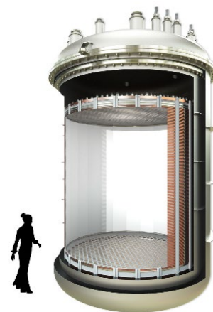
図 1 XLZD 検出器の概念図。サイズは直径 2.98 m、高さ 2.97 m となり上下に光センサーのアレイが取り付けられる。
