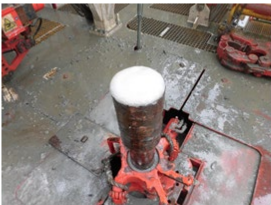
掘削中に掘削用パイプを通して、 ガスが泡状に噴出して来た事例
