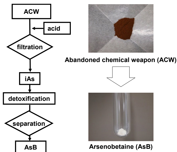
図4 遺棄ヒ素化学兵器の制御爆破処理から発生した iAs の AsB への変換[4, 9]
