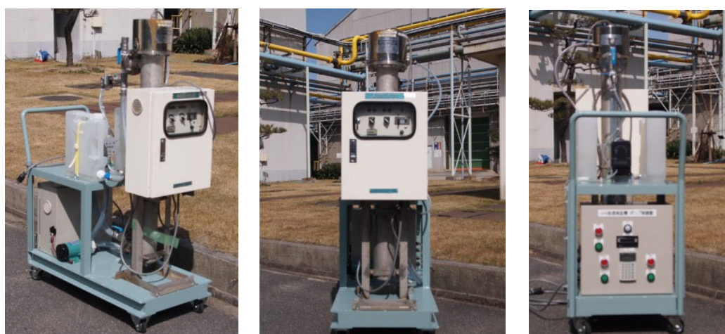
図5 iAs 汚染水の AsB への変換に関する自動処理装置（移動処理装置の実証モデル）[4, 9]
