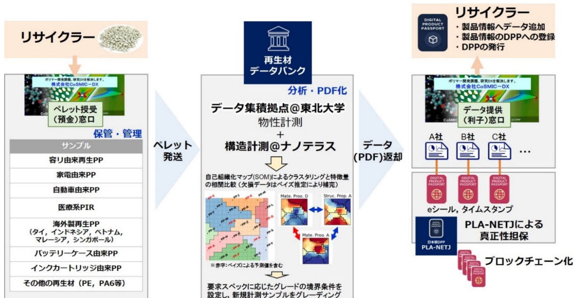
図4 ナノテラスの高度素材計測を組み込んだ再生プラスチックの循環性向上のための品質分析データバンク構築
