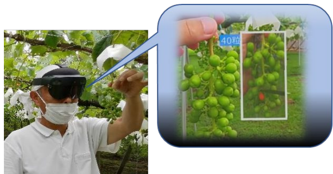
図3 葡萄粒摘作業を支援する スマート農業システム
