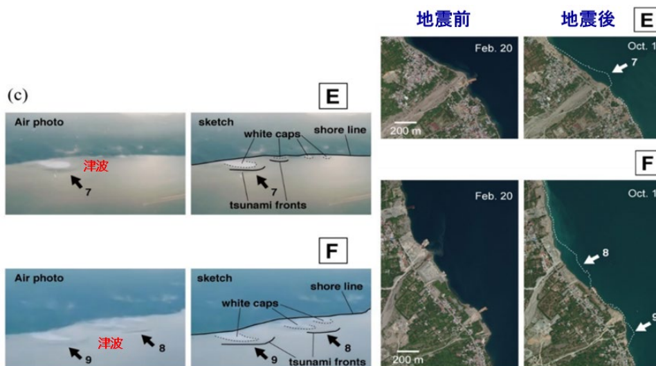
図 2-3 液状化による沿岸・海底地すべり津波
