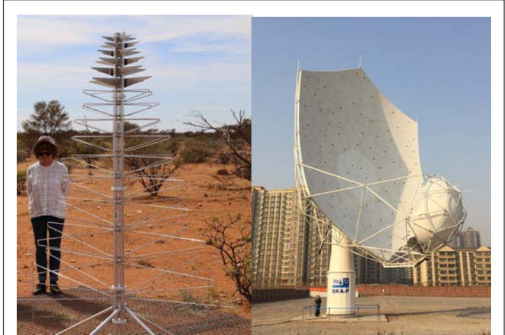
図1 西オーストラリアに設置予定のSKA1-LOWのプロトタイプ(左)と、南アフリカに設置予定のSKA1-MIDのプロトタイプ(右)。
