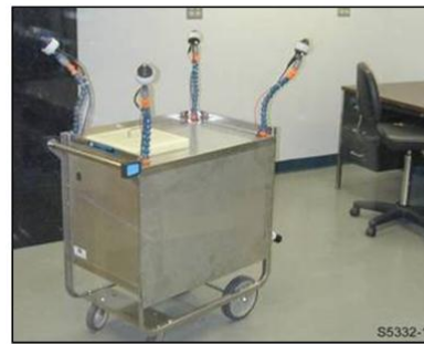
付図4 静電気エアロゾル除染の例 (QinetiQ 社のご好意による)
