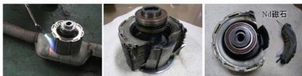
ガスバーナーによる消磁    電磁鋼板切断(内装Nd磁石)    Nd磁石    電磁鋼板切断(内装Nd磁石)
