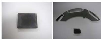
Nd磁石(71g×16枚)    切断電磁鋼板+Nd磁石
