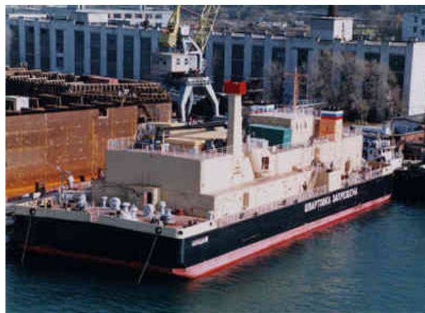
写真 2. 6－1 バージ式液体放射性廃棄物処理施設「すずらん号」（文献(9)）
