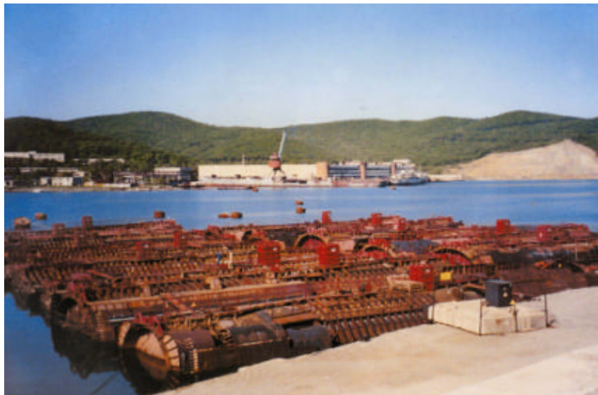
写真 2 . 6 - 4 埠頭に長期繋留保管されている解体原潜の原子炉部分 (ロシア極東使用済み燃料・放射性廃棄物処理会社 FSUE “DaIRA0” 社のパンフレット より転載)
