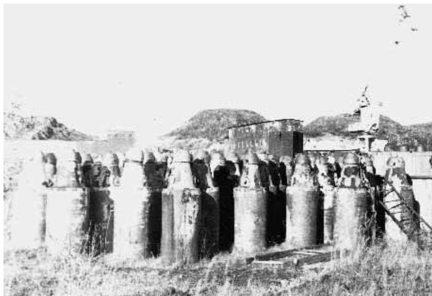
写真 2 . 6 - 5 野ざらしになっている使用済み燃料入りキャスク (容器) (文献(12)、Bellona Foundationの許諾を得て使用)
