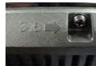
手解体の容易化(ねじ位置と種類を表示)
