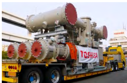
一体輸送が可能な550kV GIS(2017年12月製品化)
