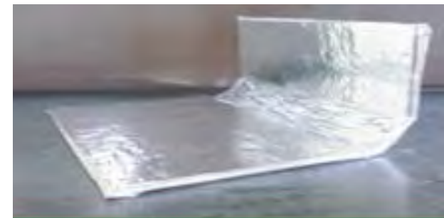
フレキシブル真空断熱パネル(冷蔵庫用)
