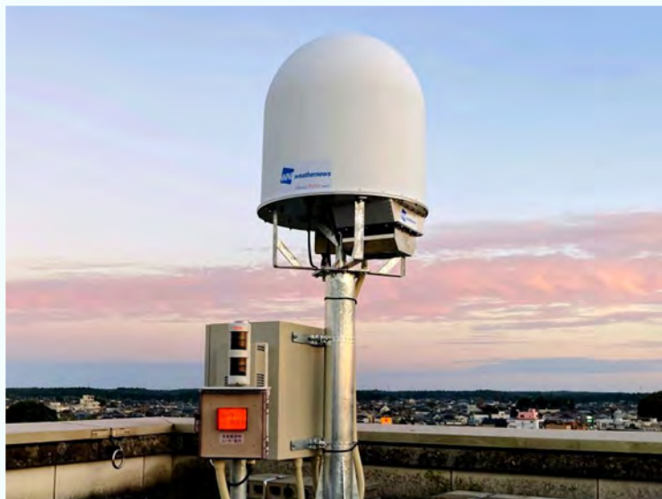
50kmの範囲を30秒でボリュームスキャンするWNI最新型Xバンドレーダー「EAGLE Radar」
