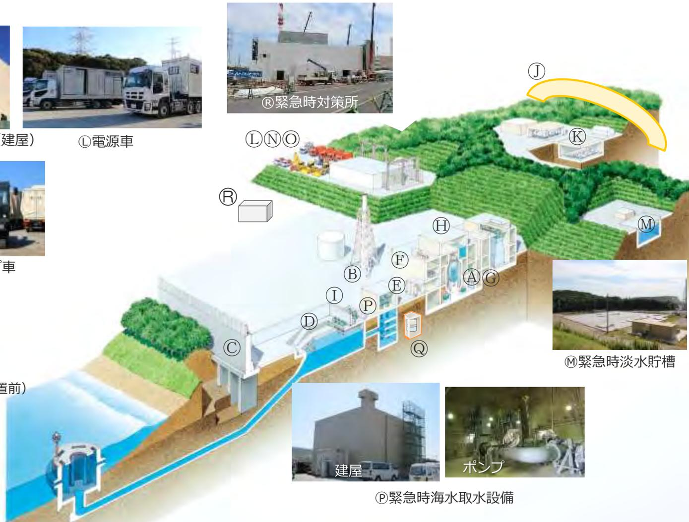
■ 発電所敷地前面（海岸沿い）にある高さ海拔10～15mの砂丘堤防にて津波を防護
