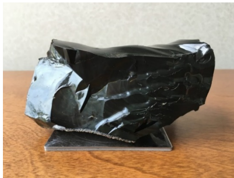
付図 3-10 ヒ素 ( \text{As}_2\text{O}_5 に換算して) 20%含有のガラス固化体
