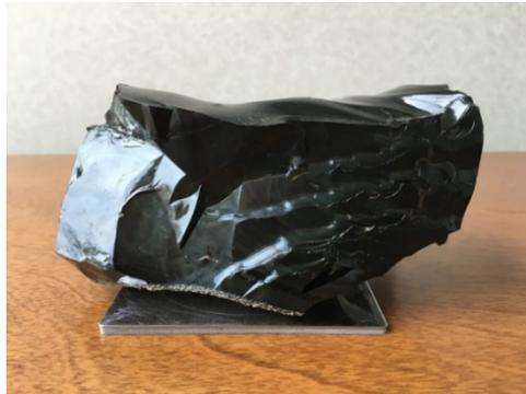
付図 3-10 ヒ素 ( $\text{As}_2\text{O}_5$  に換算して) 20%含有のガラス固化体
