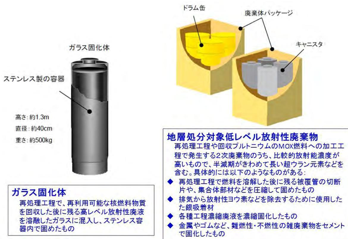
参考図 2.5 ガラス固化体及び地層処分対象低レベル放射性廃棄物イメージ図[5]
