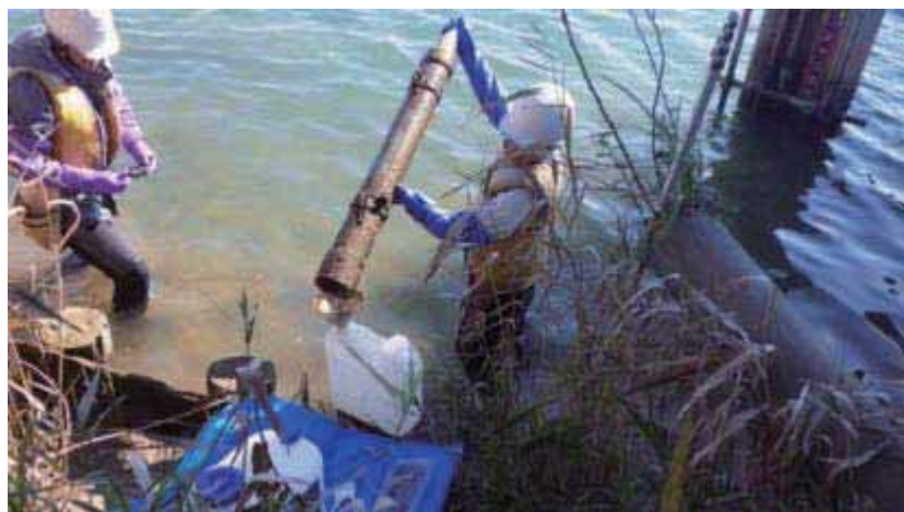
浮遊砂サンプルの回収作業
