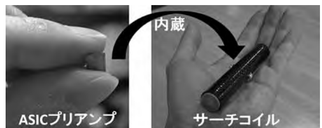
図2：磁界センサの小型化
